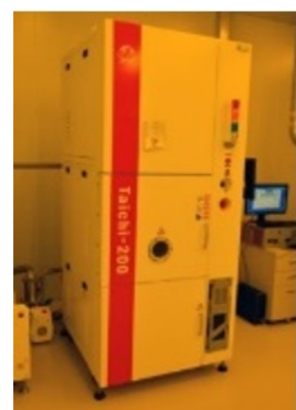
異質貼合設備
